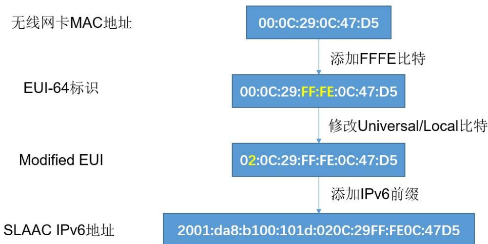
图4.2 生成SLAAC IPv6地址的基本流程
