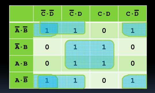
$$Y = \overline{B} \cdot \overline{C} + B \cdot D + \overline{B} \cdot \overline{D}$$
