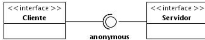
Figura 2.10: Ejemplo de la nueva notación de interfaces
